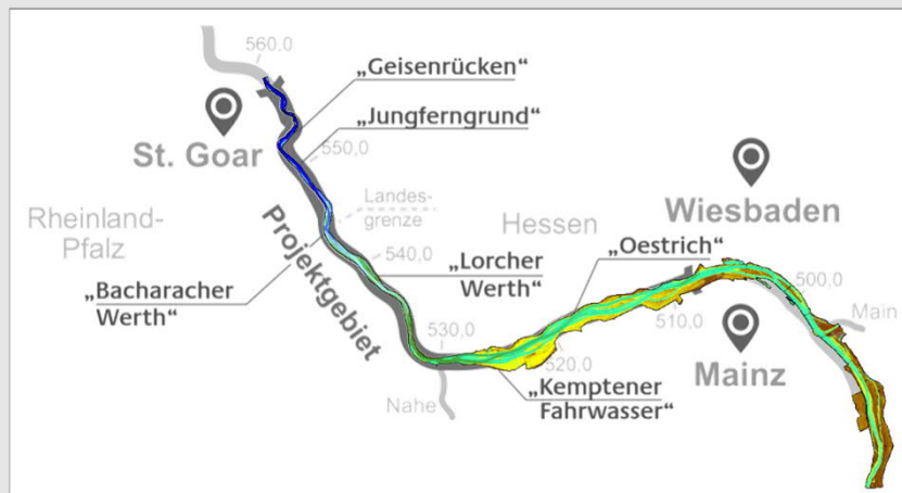
2-dimensionales numerisches Strömungsmodell Mainz – St. Goar
