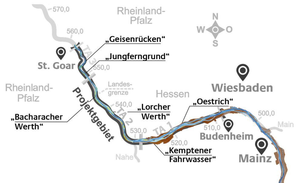
Das Modell wird in einem ersten Schritt für den Ist-Zustand der Projektstrecke für Abflüsse von Niedrig- bis Hochwasser betrieben. Auf Basis der Simulationsergebnisse, ergänzt um Informationen aus Naturmessungen, lassen sich abflussabhängige, funktionale Zusammenhänge in der Strecke verdeutlichen – eine wichtige Voraussetzung für die Entwicklung flussbaulicher Maßnahmen. Darüber hinaus dienen die Simulationsergebnisse als Bewertungsmaßstab für die untersuchten Maßnahmen.
