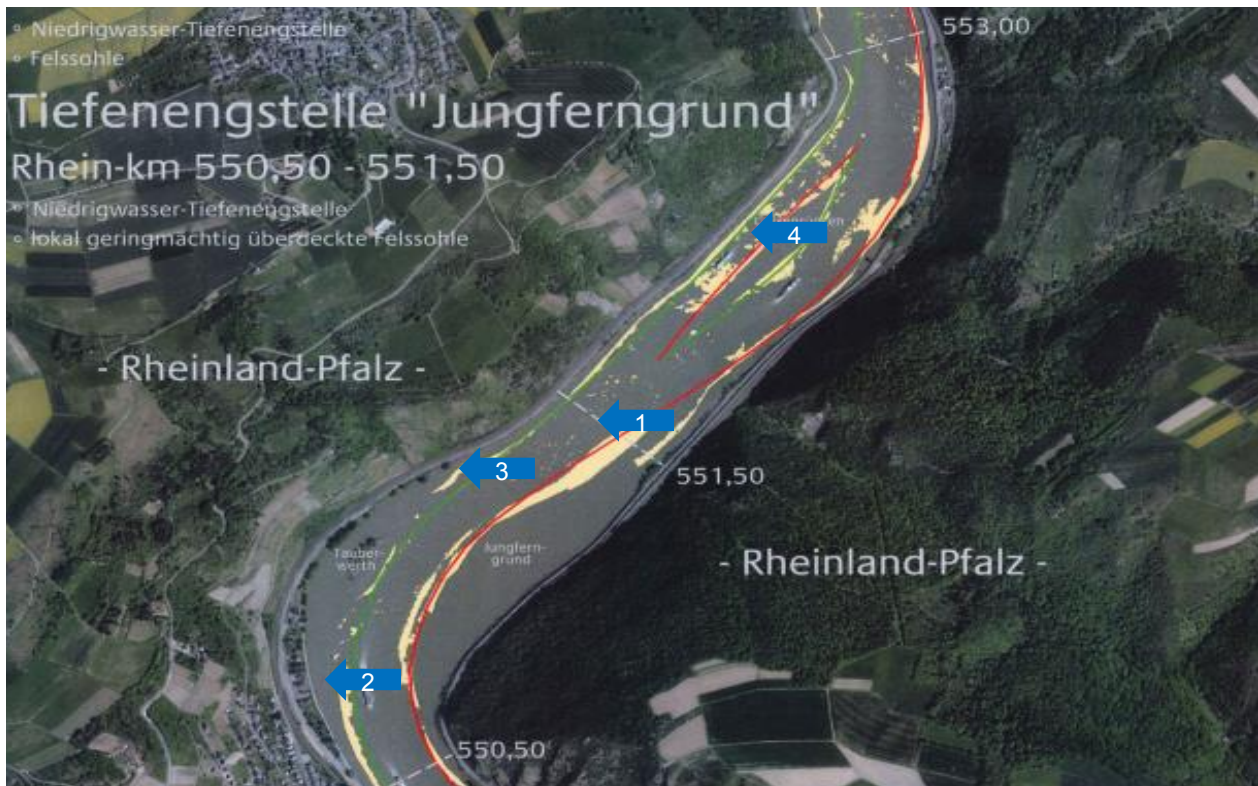
Abbildung 11: Tiefenengstellen Jungferngrund und Geisenrücken – Workshop Schifffahrt
